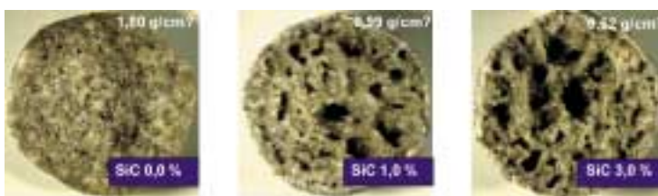
Bild 19: Ausbildung der Poren in Granulaten auf der Basis von Mauerwerkabbruch und Porenbeton
