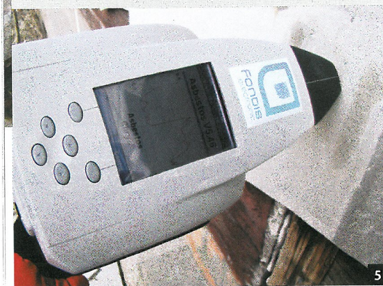
Abb. 4: Um die Messung durchzuführen, wird der Lichtstrahl des Analysators auf das ausgewählte beziehungsweise präparierte Oberflächenareal der Probe gerichtet.
