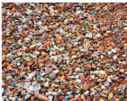
Abb. 7: RC-Baustoff aus Mauerwerkbruch
