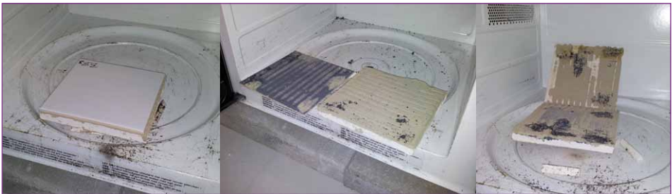
Bild 11: Probekörper mit Fliesen vor (links) und nach der Mikrowellenbehandlung (Mitte und rechts)
