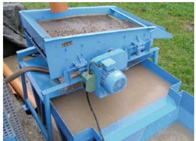
9c Leichtgutaustrag auf das Entwässerungssieb Light material discharge onto the dewatering screen
