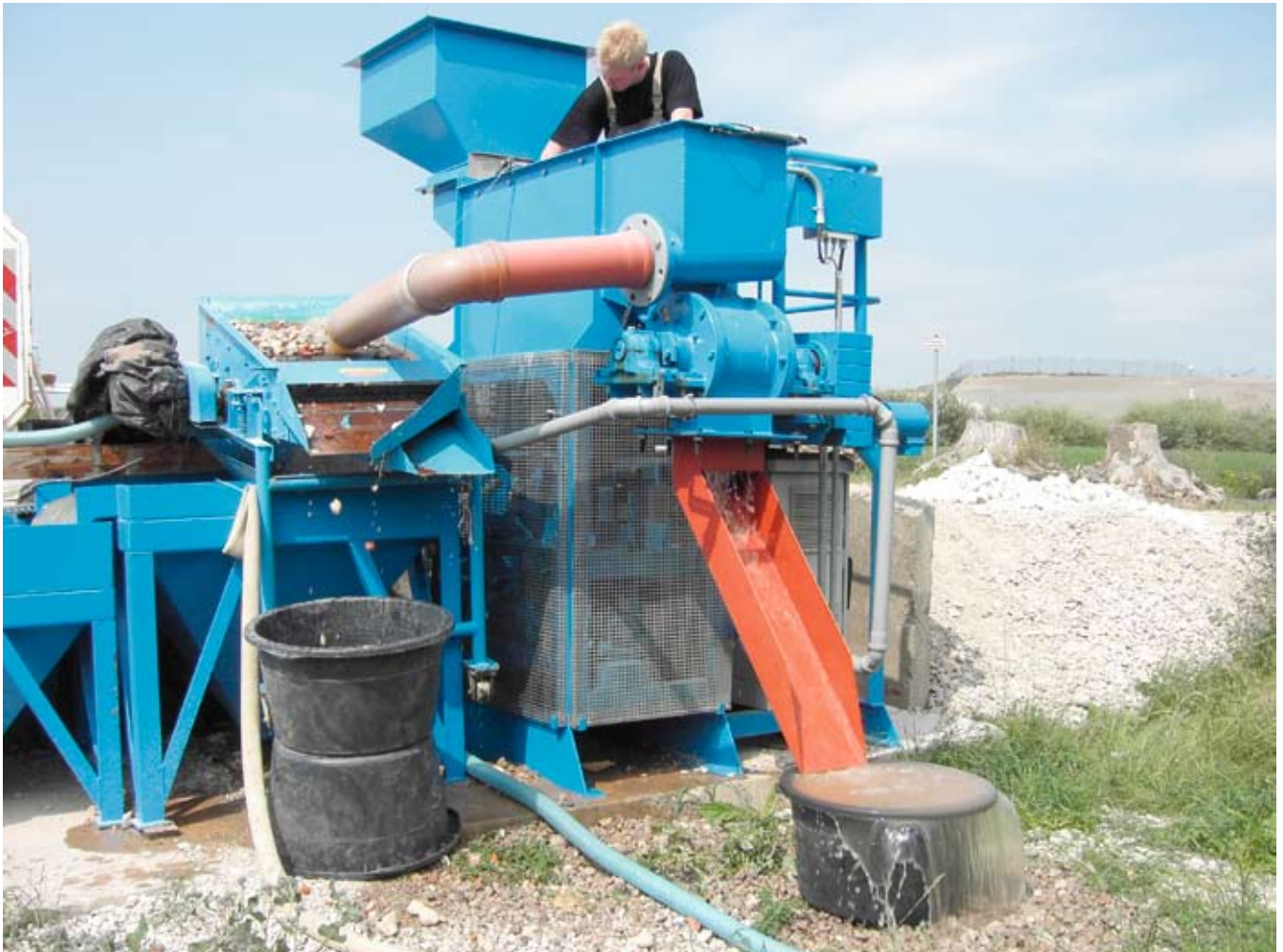
Nasssetzmaschine während des Versuchsablaufs • Wet jigging machine during the experimental procedure
