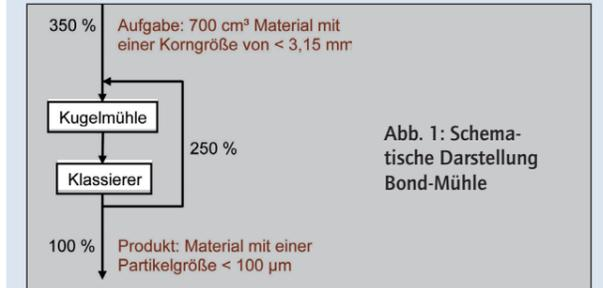
Abb. 1: Schematische Darstellung Bond-Mühle
