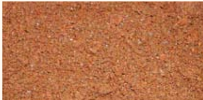
Ziegel fein Rohdichte: 1.869 kg/m 3
