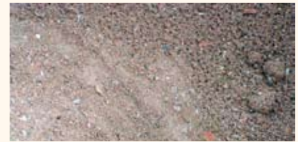
Motte (Vorsiebmaterial) Rohdichte: 1.922 kg/m 3
