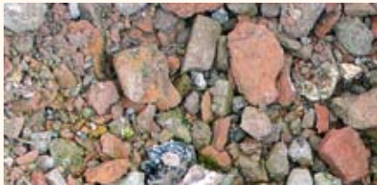
Mauerwerkbruch (44 % Ziegelanteil) Rohdichte: 2.042 kg/m 3
