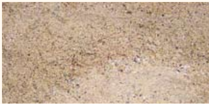
Natürlicher Sand Rohdichte: 2.530 kg/m 3
