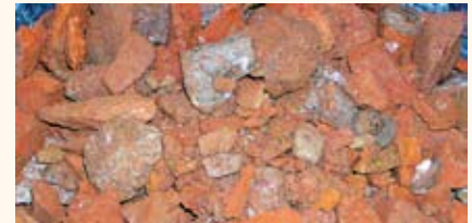
Ziegelbruch (75 % Ziegelanteil) Rohdichte: 1.941 kg/m 3
