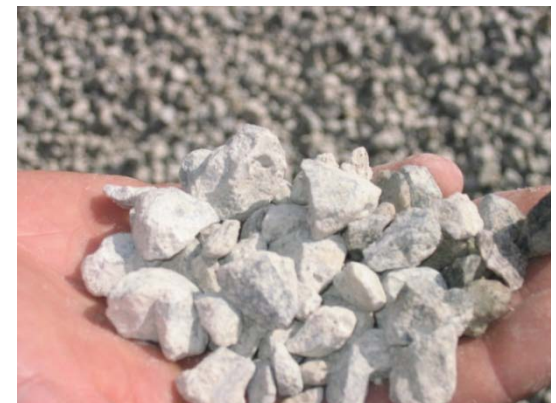
Output: Betonsplitt gewaschen
