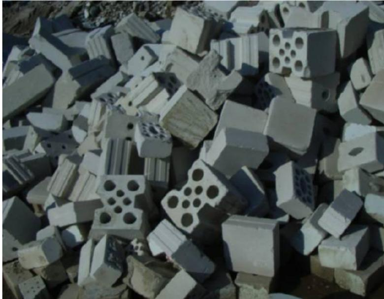
**Bild C13:** Haufwerk Kalksandstein KS 2
