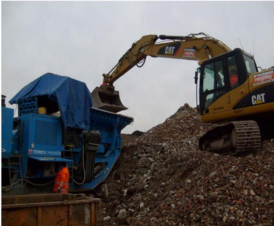
Beschickung der Brecheranlage
