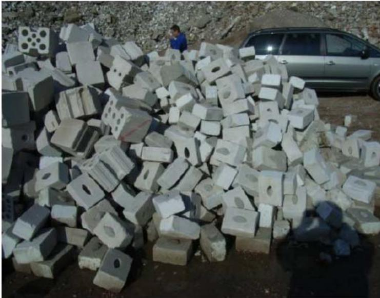
**Bild C15:** Haufwerk Kalksandstein KS 3
