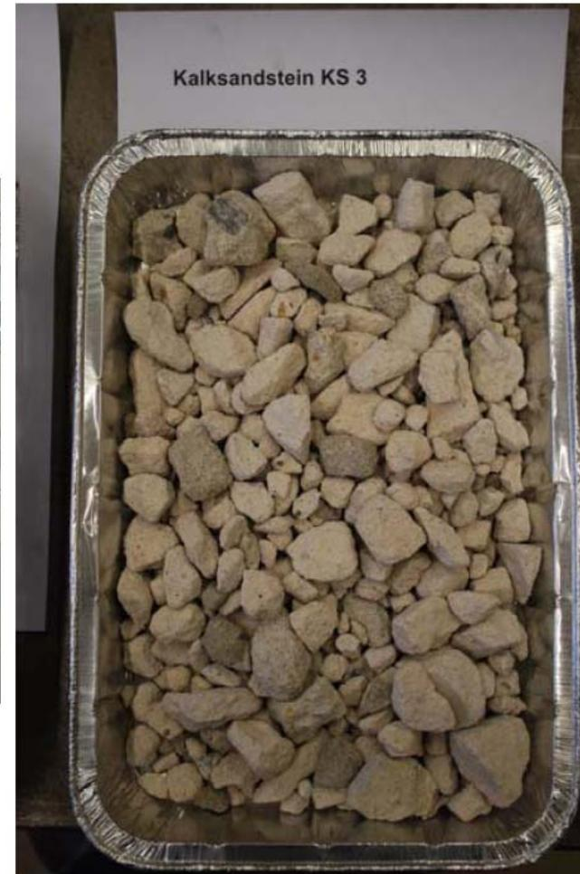
**Bild C16:** aufbereitete Probe KS 3
