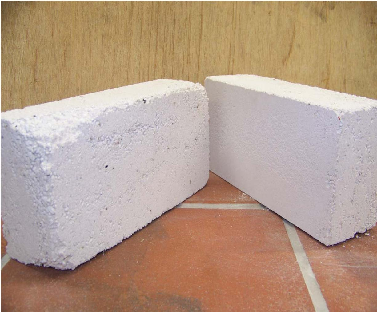
Zugabe von 50 M.-% sortenreinem Kalksandstein-Recycling-Material der groben Fraktion 2/4 mm - Reduzierung des Pressdrucks - deutlicher Aufraueffekt
