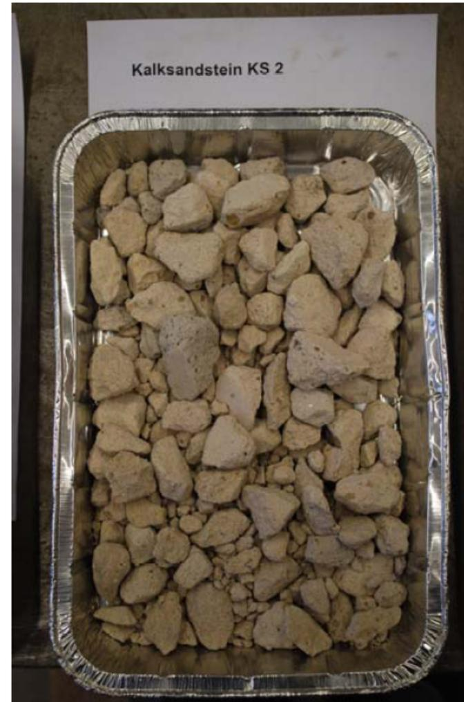
**Bild C14:** aufbereitete Probe KS 2
