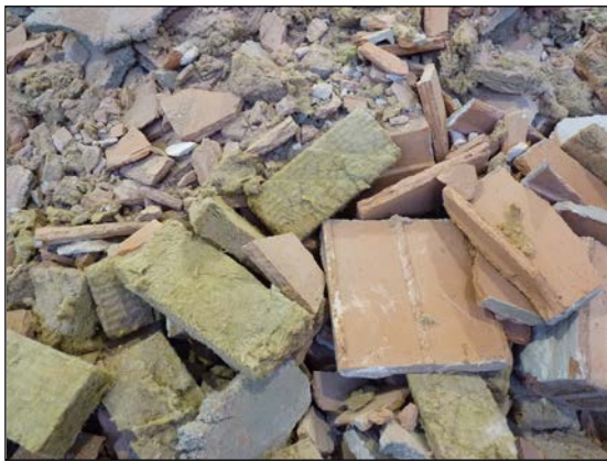
Abb. 7: Ziegelabbruch mit integrierter Mineralwolle und Gipsputz
