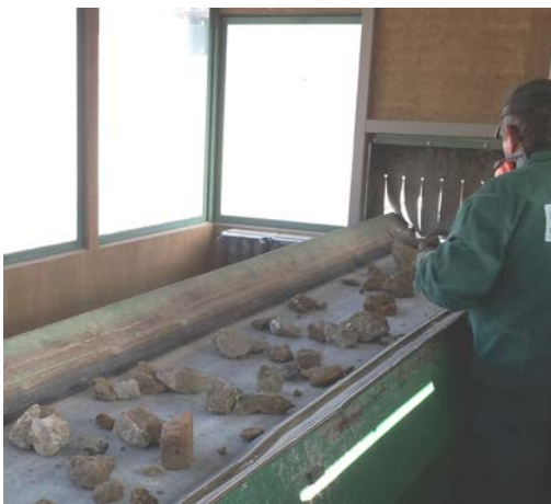
Abb. 3: Händische Sortierung grobzerkleinerter RC-Gesteinskörnungen
