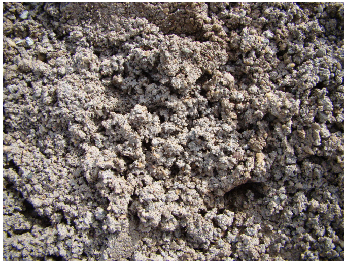
Abb. 5: Krustenbildung und Aggregationen auf der Oberfläche von RC-Sanden
