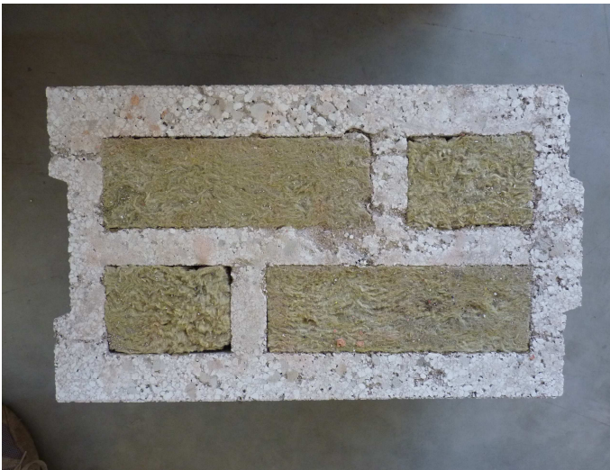
Abb. 2: Ziegel mit anhaftendem Mörtel bzw. Leichtbetonstein mit Wärmedämmfüllung
