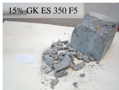
Abb. 14: Ansichten des Zerkleinerungsgutes der Betonwürfel nach der Mikrowellenbehandlung
