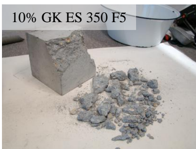
Abb. 14: Ansichten des Zerkleinerungsgutes der Betonwürfel nach der Mikrowellenbehandlung
