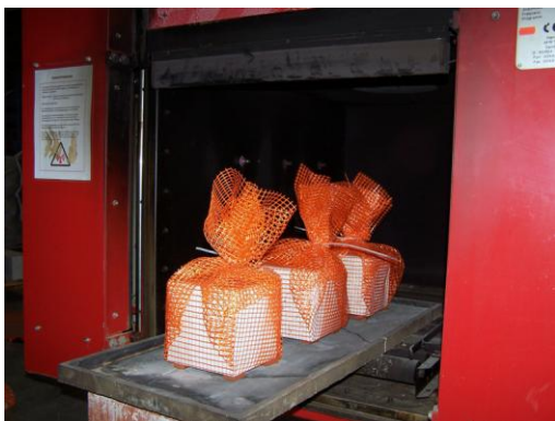
Abb. 7: Betonwürfel 15x15cm im Glasvlies
