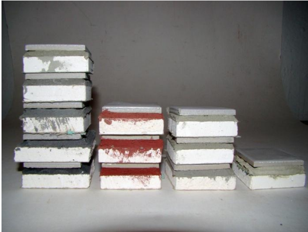
Abb. 4: Probekörper Gipskartonplatte + Fliese und Suszeptoren im Fliesenkleber
