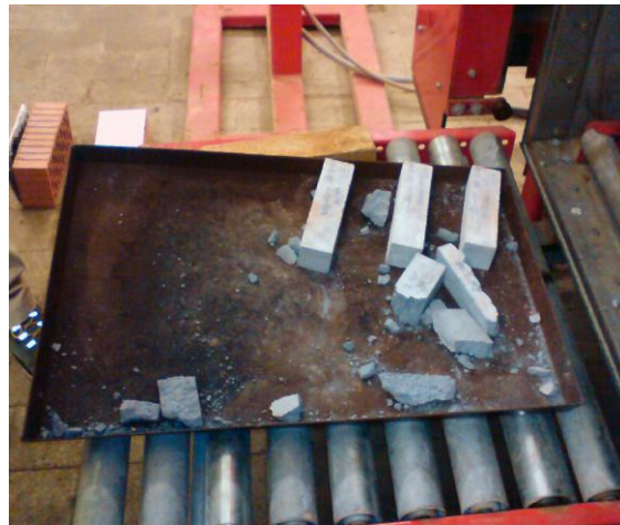
Abb. 3: Zementmörtelprismen mit und ohne Mikrowellensuszeptor direkt nach der Mikrowellenbehandlung
