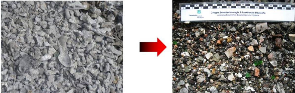
Zur Simulation der in der konventionellen Aufbereitung üblichen 3-monatigen, feuchten Lagerung zur Alterung der Schlacken wurde ein Teil der Proben für vier Wochen unter Wasser gelagert, um diese später mit den Produkten aus der Fragmentierung zu vergleichen.
