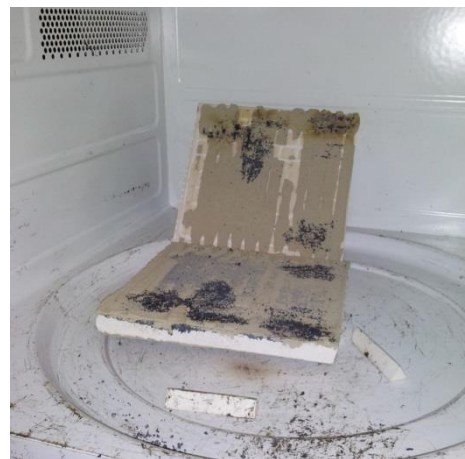
Bild 11: Probekörper mit Fliesen vor (oben) und nach der Mikrowellenbehandlung (unten)
