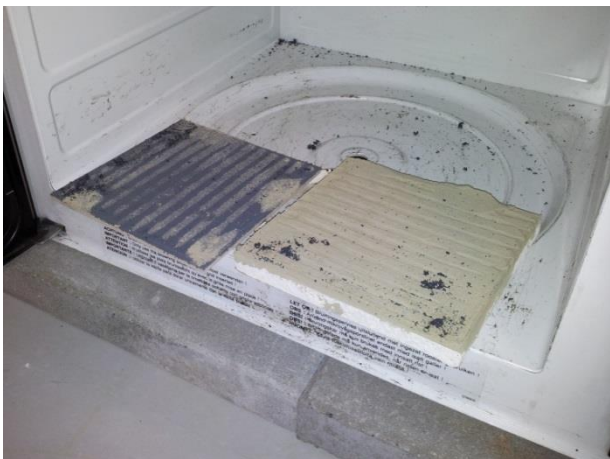
Bild 11: Probekörper mit Fliesen vor (oben) und nach der Mikrowellenbehandlung (unten)
