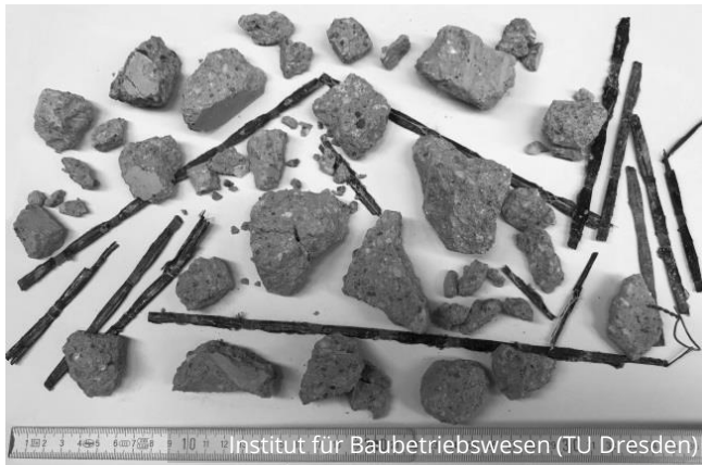
Bruchmaterial Größe 0/56, vollständiger Aufschluss
