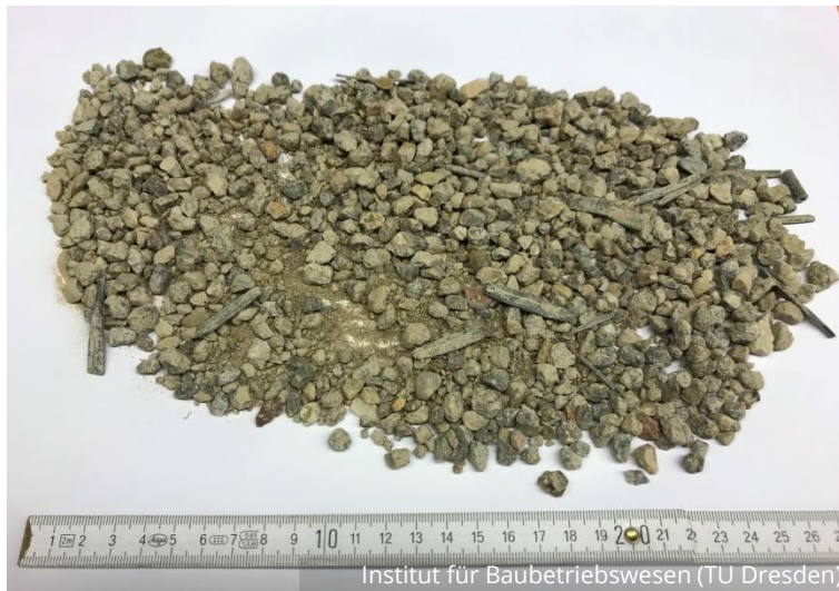
3. Durchgang „Brechen“ und „Windsichten“ stationäre Anlage - C 3 Material auf 0/10 gebrochen
