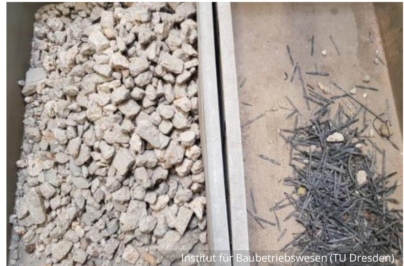
Nahezu sortenreines Outputmaterial Beton 0/56 und Carbonbewehrung
