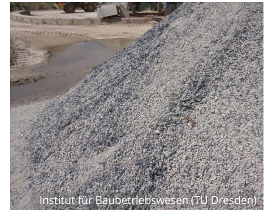
Ergebnis: C 3 -Betonrezyklat 0/16 mit Carbonfasern
