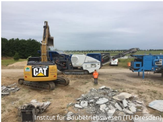
Aufgabe des C 3 -Materials in den Backenbrecher
