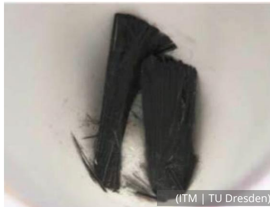
Einzelprobe nach der Pyrolyse bei 550°C
