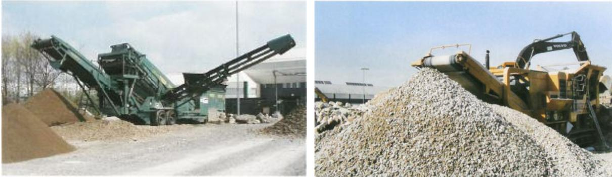
ABBILDUNG 4: MOBILE SIEBANLAGE (LINKS) UND MOBILER BRECHER (RECHTS)<sup>86</sup>
