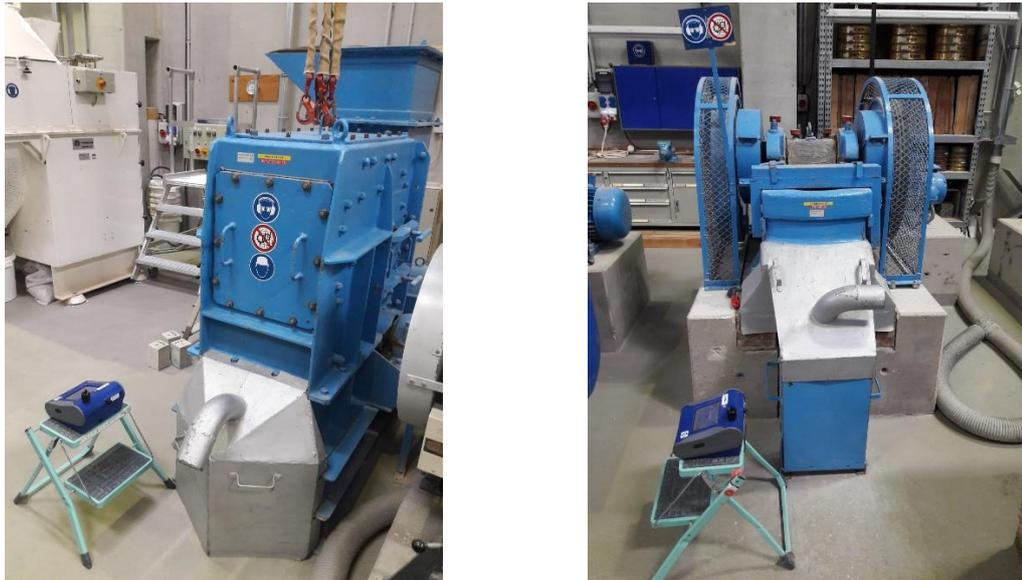
**Abbildung 30:** Position des mobilen Staubmessgerätes am Prall- (links) und Backenbrecher (rechts)
