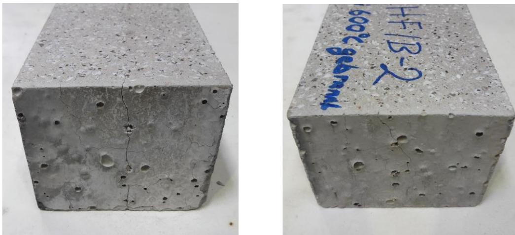
**Abbildung 23:** Rissbildung an den thermisch vorbehandelten Probekörpern HF/A (links) und HF/B (rechts)
