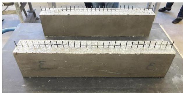
**Abbildung 18:** Ausgeschalteter normalfester Carbonbetonbalken
