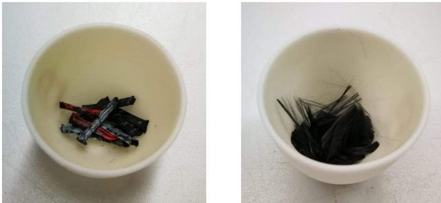
**Abbildung 16:** Carbonbewehrung B vor (links) und nach (rechts) dem Glühverlust-Versuch
