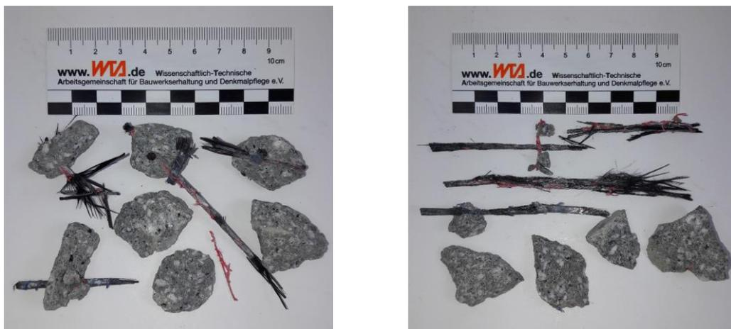
**Abbildung 54:** Aufschluss der Carbonbewehrung der Fraktion 16/31,5 mm des Carbonbetons HF/B ohne Vorbehandlung mit dem Prall- (links) und Backenbrecher (rechts)
