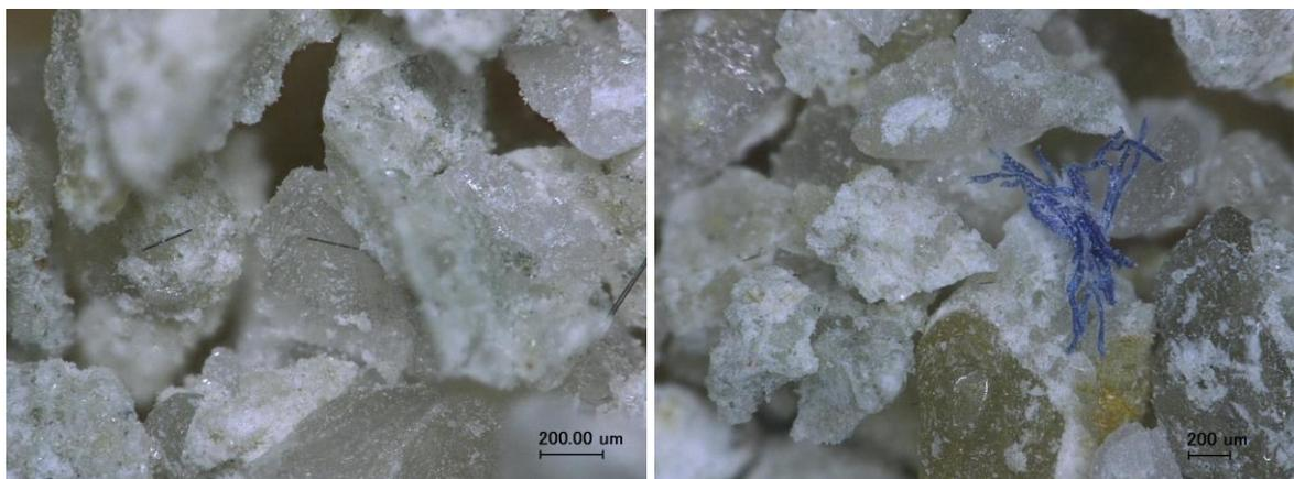
**Abbildung 49:** Carbonfasern (links) und Bindfäden (rechts) im Carbonbetonstaub NF/B-BB-keine VB
