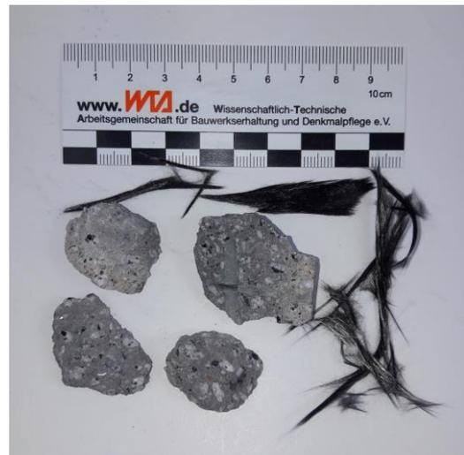
**Abbildung 68:** Aufschluss der Carbonbewehrung der Fraktion 16/31,5 mm des Carbonbetons HF/A ohne (links) und mit thermischer Vorbehandlung (rechts)
