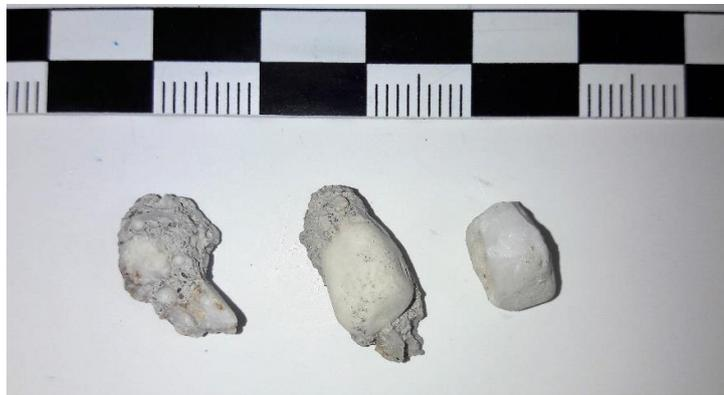
**Abbildung 14:** Einstufung rezyklierter Gesteinskörnung in 0 %, 50 % und 100 % Aufschlussgrad (von links nach rechts)
