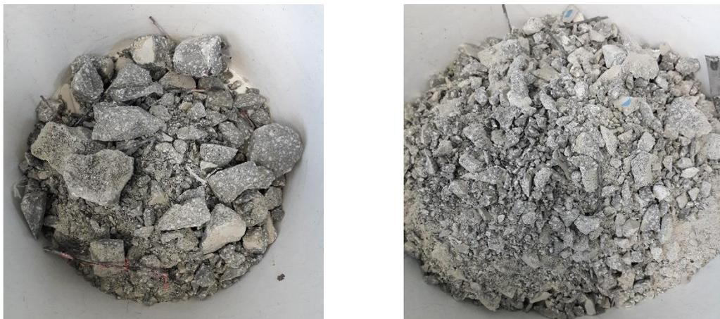
Abbildung 21: HF/B-Rezyklat aus dem Prall- (links) und Backenbrecher (rechts)
