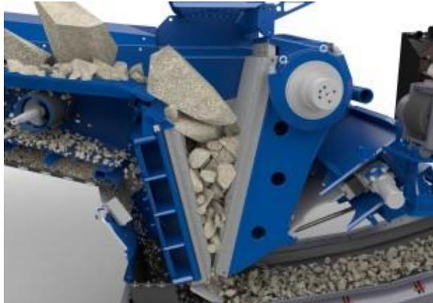
**Abbildung 4:** Funktionsprinzip eines Backenbrechers [II]
