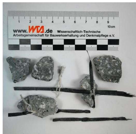
**Abbildung 69:** Aufschluss der Carbonbewehrung der Fraktion 16/31,5 mm des trockenen (links) und umgebungsfeuchten (rechts) Carbonbetons HF/A mit Mikrowellen-Vorbehandlung
