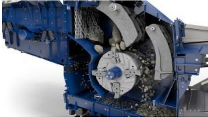
**Abbildung 5:** Funktionsprinzip eines Prallbrechers [II]
