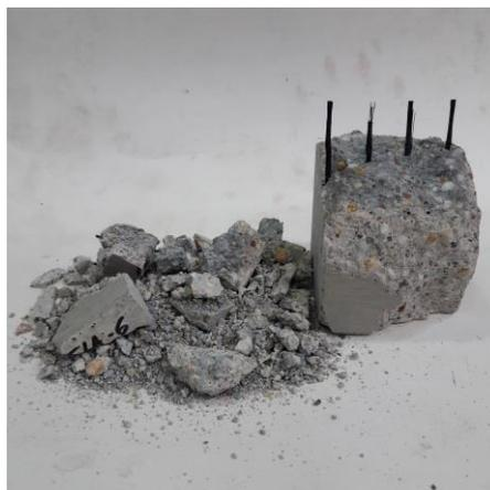
**Abbildung 25:** Nach Mikrowellen-Vorbehandlung explodierter Probekörper NF/A\*-umgebungsfeucht
