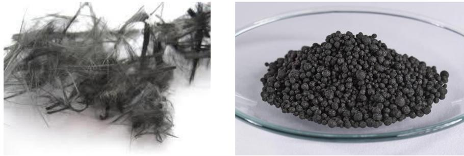
**Abbildung 12:** Rezyklierte Carbonfasern nach dem Pyrolyseprozess (links) [K6], Fiberballs (rechts) [M3]
