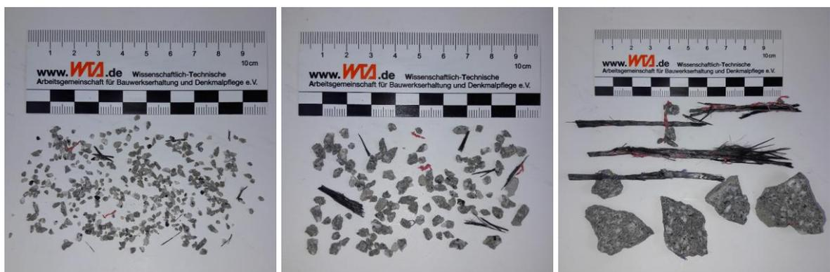
**Abbildung 44:** Fasern im nicht vorbehandelten Carbonbeton-Rezyklat HF/B-BB der Fraktion 1/2 mm (links), 2/4 mm (mittig) und 16/31,5 mm (rechts)
