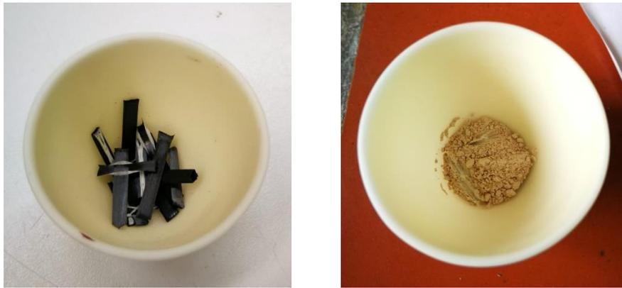
**Abbildung 15:** Carbonbewehrung A vor (links) und nach (rechts) dem Glühverlust-Versuch
