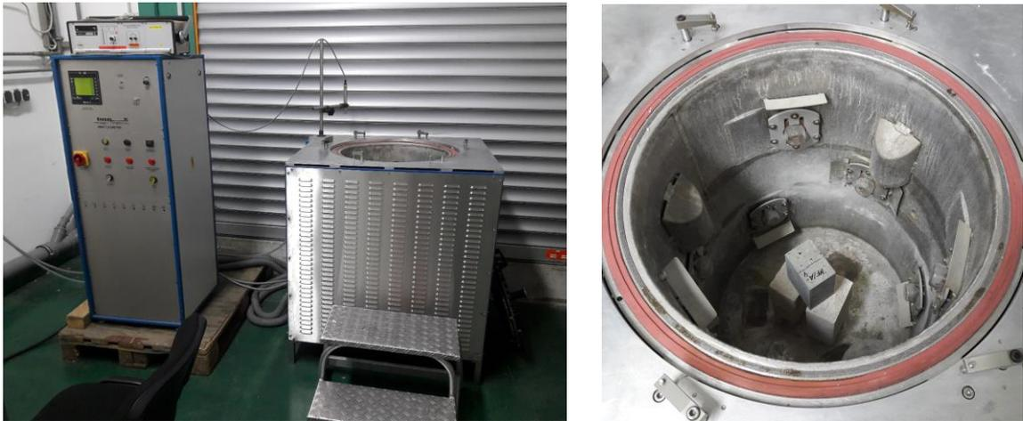
**Abbildung 24:** Mikrowellenkammerofen (links), Versuchsaufbau innerhalb des Kammerofens (rechts)
